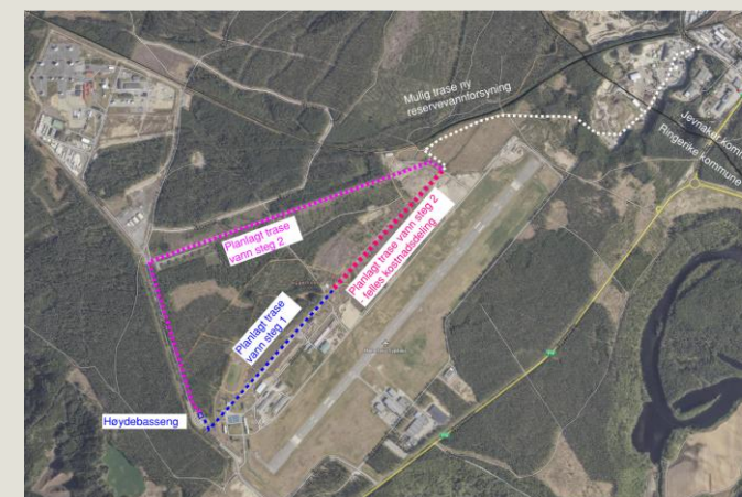
Høydebasseng og planlagte rørtraséer på Eggemoen. Hvit stiplet linje viser mulig rørtrasé for påkobling på vannverk i Ringerike kommune.
